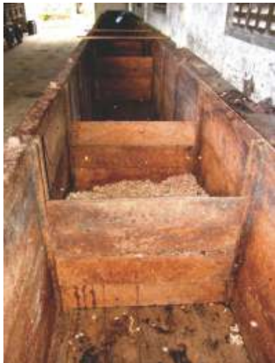
Cocho de madeira para fermentar cacau.
